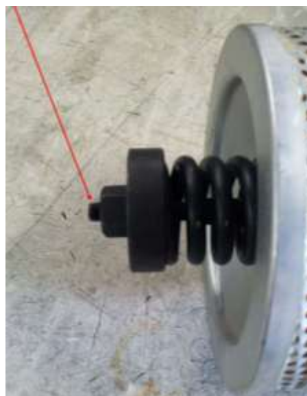
Рис. 10.13.2 Фильтр сливной в сборе 1 – фильтроэлемент; 2 – шпилька; 3 – пружина; 4 – крышка; 5 – гайка; 6 – шайба; 7- пружина. Выступающая часть резьбовой части шпильки на фильтре должна составлять 7-8 мм.
