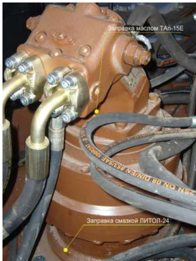
9.4.5 Центральный коллектор Место смазки центрального коллектора место заправки смазкой литол 24
